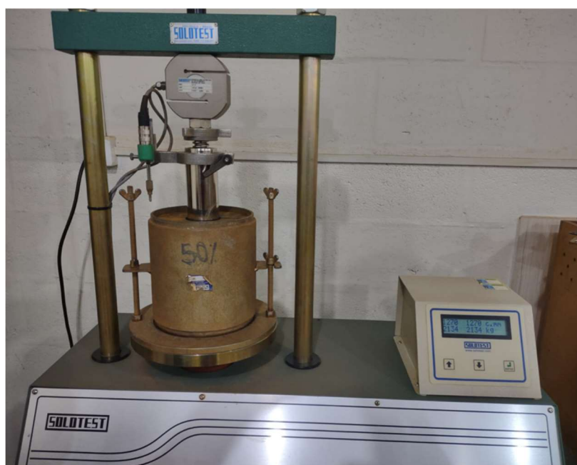
Figura 8. Execução da penetração do pistão no corpo de prova.
